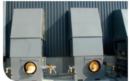
Schneckenverdichter mit Zentrierschienen für die genaue Positionierung der Container
