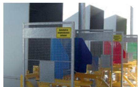
Kippvorrichtung für 660 - 1100 Liter Container einsetzbar für jede Art von Aufstellung
