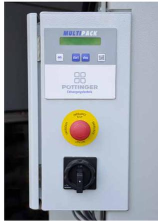
Automatik-Bedienung - Hoher Bedienkomfort. Die Anwesenheit eines Bedieners während des Pressvorganges ist nicht erforderlich.
