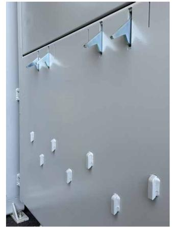
Bewegliche und fixe Rückhaltekrallen für eine höhere Verdichtung expandierender Materialien zB Folien
